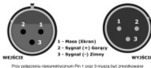
Rys. 1.4 Typy złączy audio
